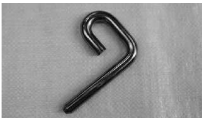
31 pav. Kaištis 13 mm šachtos kampui
