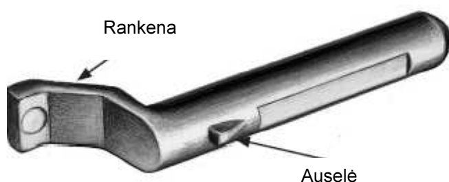
32 pav. Kaištis jungčiai. Fiksuoja šachtos kampo jungtį su šachtos kampu.
