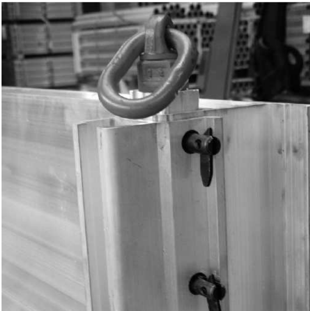
25 pav. 3-D kėlimo kilpos montavimas
